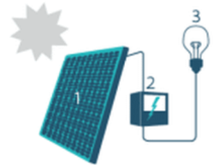
1. Zonnepaneel | 2. Omvormer | 3. Elektrische toestellen
